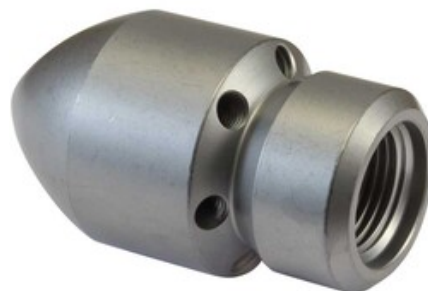
Vysokotlaká kanalizační tryska Granát 30° 500bar 3/8" 6+1 (120)
