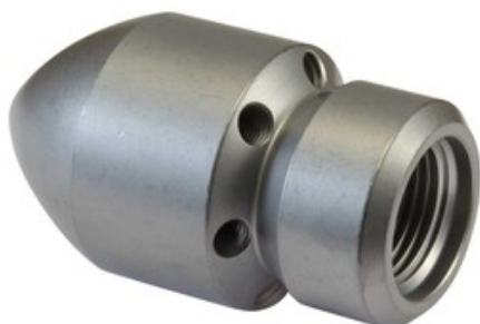
Vysokotlaká kanalizační tryska Granát 30° 500bar 3/8" 6+1 (100)
