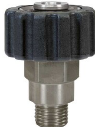
Vysokotlaké šroubení 1/4"M s převlečnou maticí M22x1,5F (500 bar)
