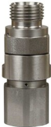
Otočné šroubení ST-351 pro vysokotlaké pistole 1/2"M-1/2"F (600bar)
